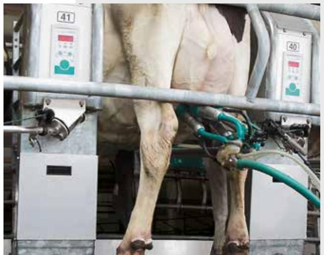
Posiform : dépose automatique, descente automatique
